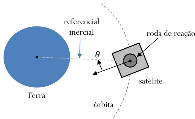
Figura 1: Ilustração de um satélite rígido em órbita terrestre.
